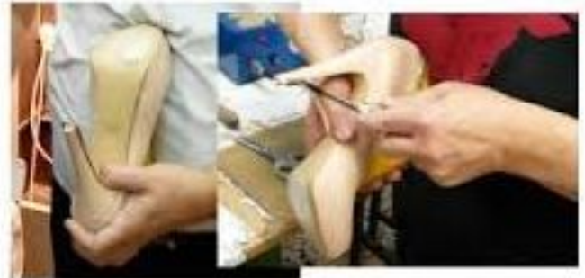
El sacado de filos o perfiles de una suela en zapatos de bottier.
