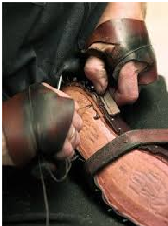
Zapatero artesano empalmillando un zapato de hombre | Valle de Elda.
