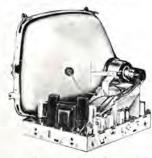
¡Sin averias de producción! Sin circuitos impresos. Alambrado a mano. Conexiones del chasis soldadas a mano. Los componentes están firmemente sujetos a la base metálica. Tubo de imagen montado en el chasis que permite una mejor accesibilidad. Cuesta más, pero significa mayor satisfacción del usuario.
