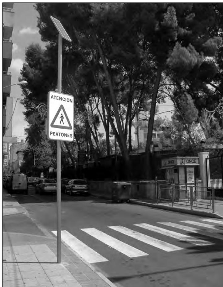
Las nuevas señales luminosas funcionan con energía solar
