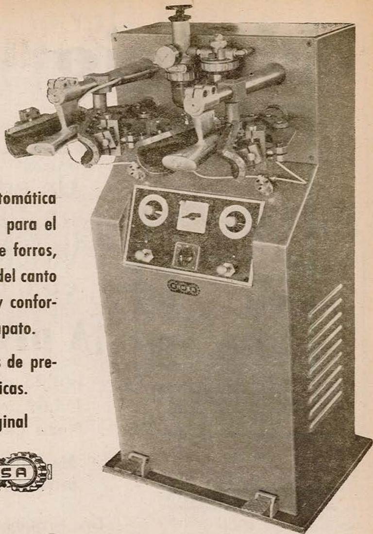
**Máquina automática y neumática para el planchado de forros, eliminación del canto del mismo y conformado del zapato.**
