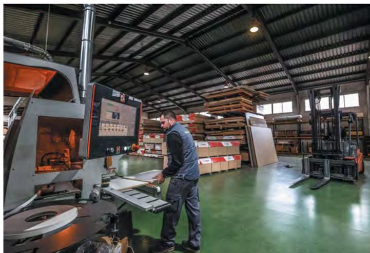
Actualmente la empresa fabrica productos semielaborados de forma mecanizada para que el carpintero solo tenga que montarlo
