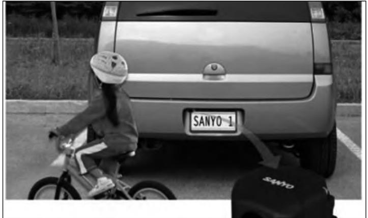
Algunos conductores se sienten inseguros al circular marcha atrás o al aparcar en espacios reducidos. Las cámaras de visión trasera reducen el riesgo de colisionar en estos casos. La cámara se sitúa en el portón trasero, se activa automáticamente al poner la marcha atrás y una pantalla ubicada en el salpicadero ofrece una visión del área posterior. La pantalla es amplia para localizar los obstáculos pequeños o incluso a los peatones. Estas cámaras
